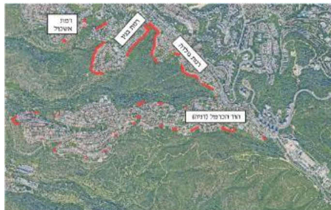
איור 7 – מפת מקטעי גידור לחסימת נתיבי גישה של חזירי בר לשכונות הגובלות עם פארק הכרמל.
